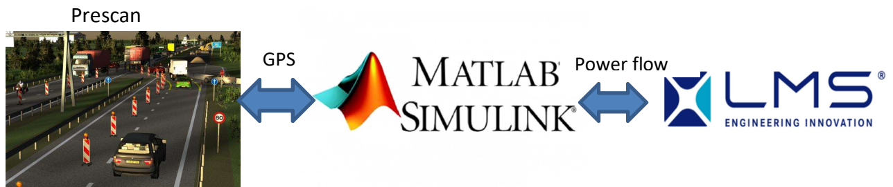
Fig. 1 Fluxul de date al cosimulării folosind Prescan, Simulink și Amesim.
